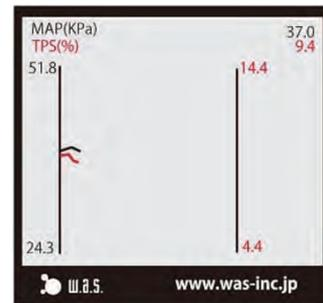
● 黒のラインで表示されているのが“MAP- 吸気圧”、赤のラインで表示されているのが“TPS, スロットルポジションセンサ”のグラフです。表示するライブデータを、自由に選択することができます。
