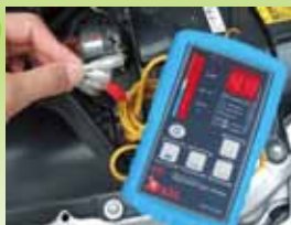
ハーネスとテストリードを接続して準備完了!
