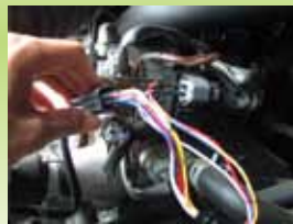
コネクタを取り外し、付属のハーネスを割り込ませます
